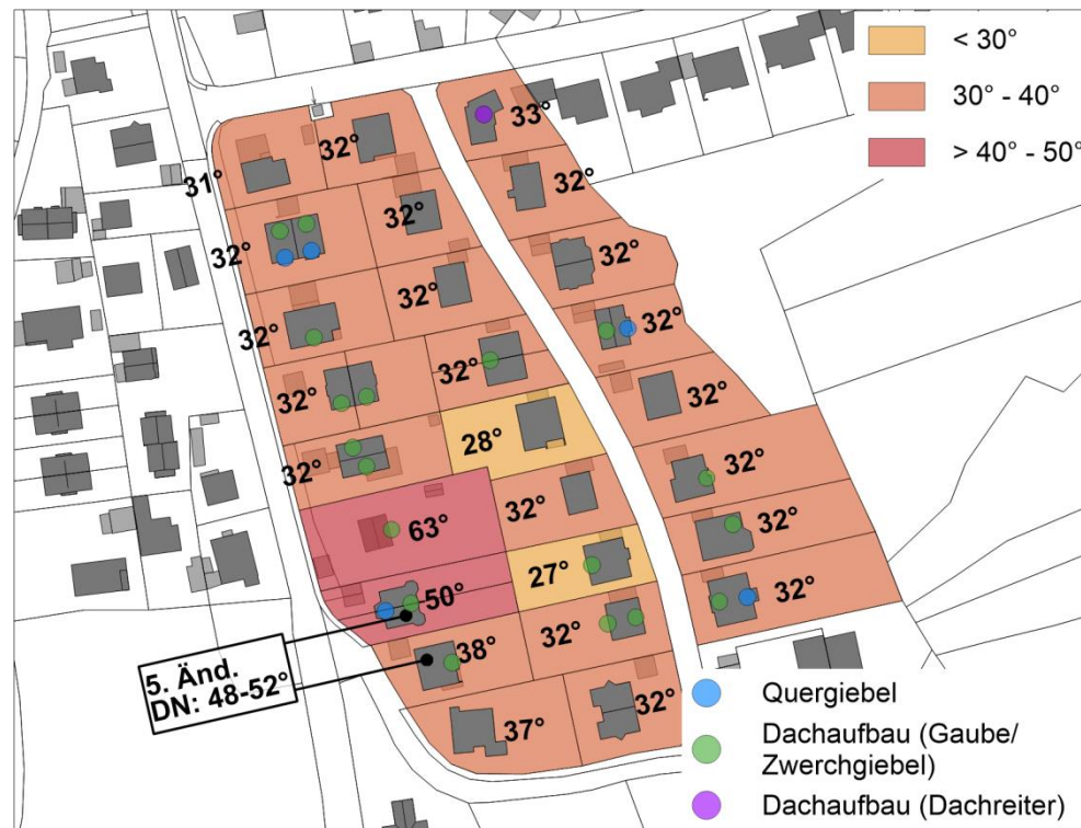
Abb. 9: Dachneigungen der Hauptgebäude gem. Bauakten mit Dachaufbauten, ohne Maßstab
